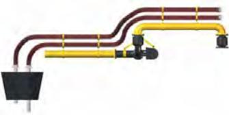
Brazo de carga con sistema de recuperación de vapores y válvula de bloqueo manual.
