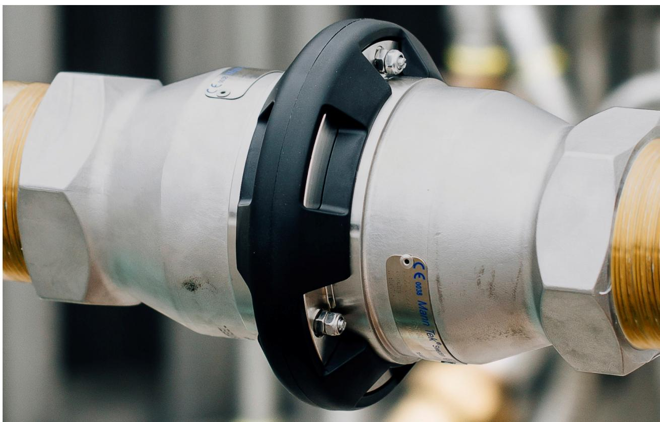
Nuestros acoples de seguridad se utilizan para evitar accidentes por arrancamiento. En caso de, p. ej. Si un camión cisterna se marcha con una manguera o un brazo de carga todavía conectado, las dos mitades del acoplamiento se separarán e inmediatamente cerrarán el flujo en ambas mitades y direcciones y, por lo tanto, evitarán accidentes y derrames no deseados de GLP.
